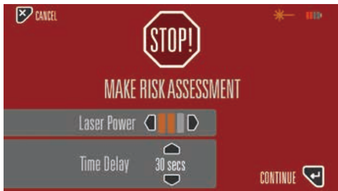
図 2. 遅延時間やレーザー出力低下を設定するためのリスク評価画面
