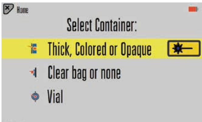
図 1. 透過型、ピンポイント、またはガラスバイアル測定の選択
