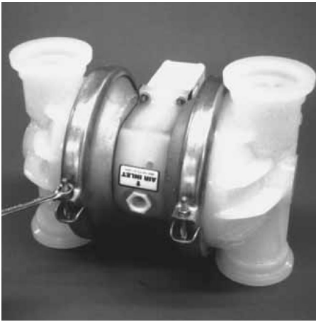
ステップ9 (写真9) 片側のリキッドチャンバーをセンターセクションに固定しているラージクランプバンド1組を取り外します。(写真9)
