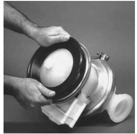
ステップ11 (写真11) 調節式のレンチを用いるか、または手でダイアフラムを(時計方向と反対方向に)回して、ダイアフラムアッセンブリーを取り外します。(写真11)
