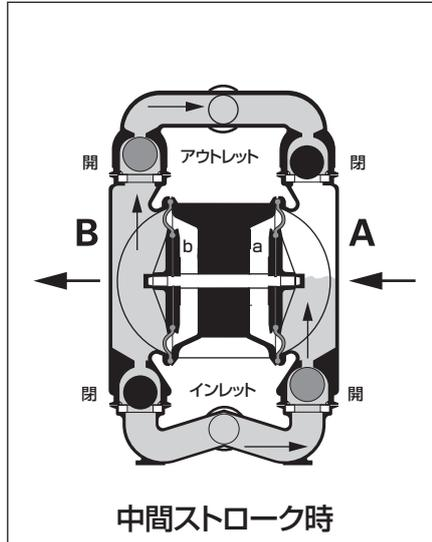
図2: A側のダイヤフラムが右ストロークの末端に到達すると、エアーバルブが切替り、供給エアーをB側のダイヤフラムの内側 (エアーチャンバー-b) へ供給を始めます。(ダイヤフラムは左側へ移動し始めます)
