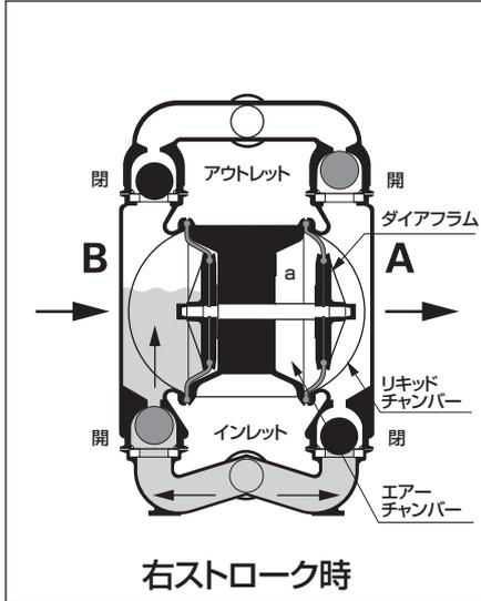
図1: エアーバルブの作動によりA側のダイヤフラムの内側 (エアーチャンバー-a) に供給エアーを送りこみます。(ダイヤフラムは右側へ移動)
