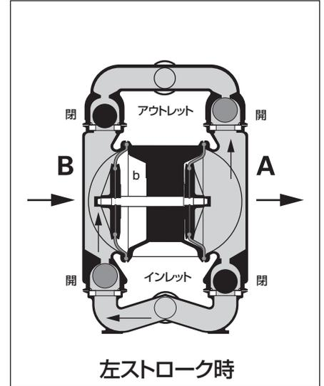
図3: B側のダイヤフラムが左ストロークの末端に達すると、エアーバルブが再度切替り、供給エアーをA側のエアーチャンバー-aにエアーを供給し始め、エアーチャンバー-b内のエアーは大気へ排出され始めます。
