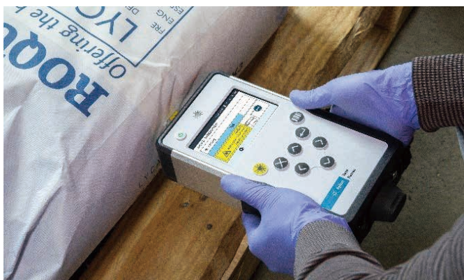
図 1. 倉庫で袋内の材料を同定するのに使用する Agilent Vaya ラマンシステムハンドヘルド分光装置
