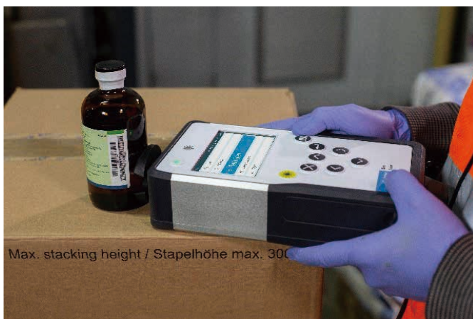
図 1. SORS 搭載の Agilent Vaya ラマンハンドヘルド分光装置を使用して、倉庫で褐色瓶越しに材料を同定している様子
