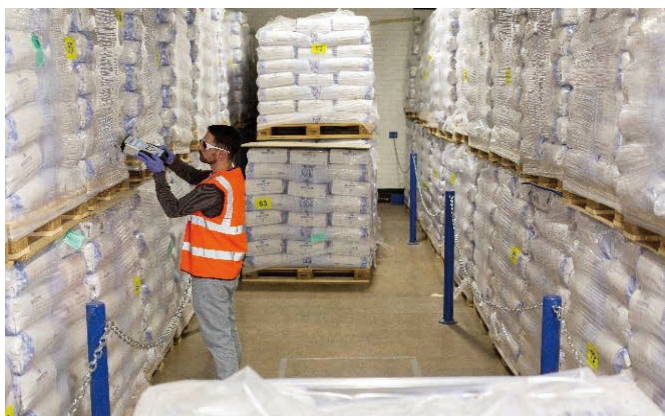
図 1. Agilent Vaya ラマンハンドヘルド分光装置を使用して、検査倉庫で紙袋越しに原材料を測定している様子
